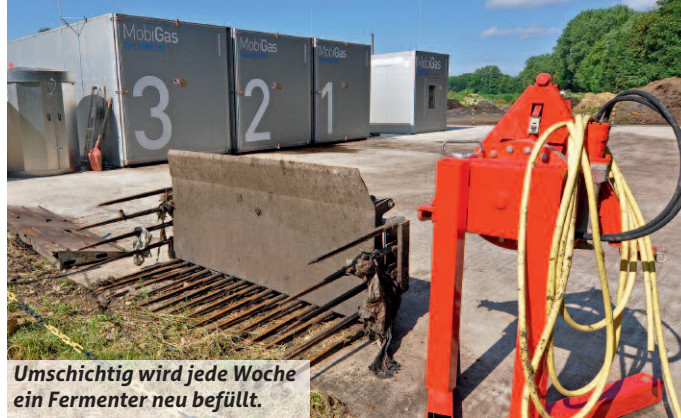
Rechts der Mietenwender, der auch zum Mischen von Gärrest und Substrat dient.
