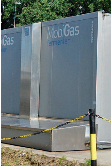
Vor dem Öffnen werden die Boxen von der Seite her belüftet, alle Leitungen sind auf der Rückseite zusammengefaßt. Fotos: Meier
